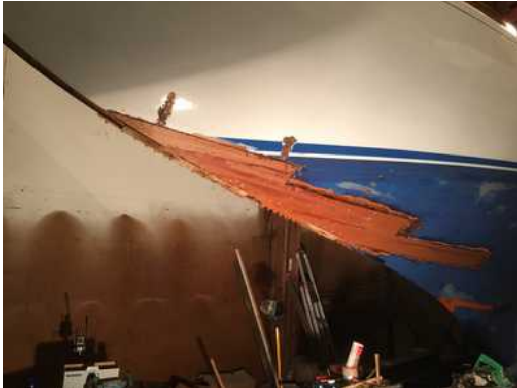
Bordläggningen klar och pluggad. Hyvling och slipning kvar
