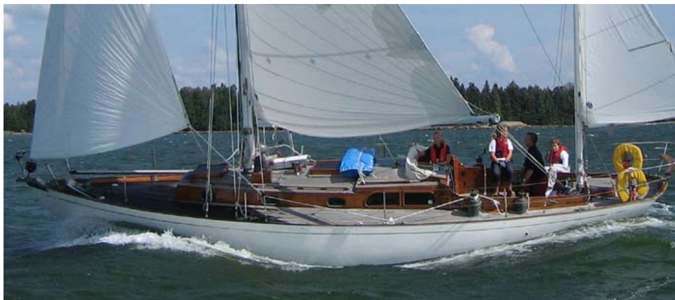
Fortare än så här kan inte Sparkman & Stephensritade yawlen Reverie segla. Almaregeln använder detta som en del av beräkningen av Almatalet. Froudetalet är här nästan 0,45, skrovfarten har uppnåtts.
