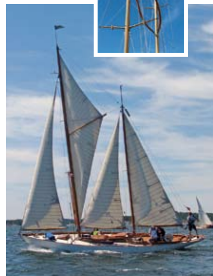
Senta med den karakteristiska wishbonekonstruktionen under Nynässeglingen.
