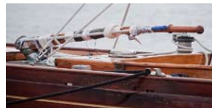
Itakas knäckta och lagade rorkult efter den dramatiska händelsen.
