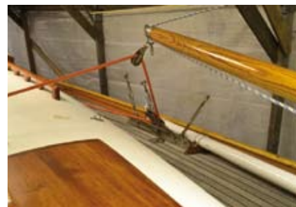
Skotning och uthal sett förifrån. Det finns en liten bygel på taket för att fästa bommen när den inte används.
