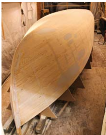
Prototypbåten med limmade ribb på CAD-ritade spant.
