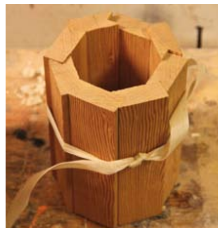
Modell som visar hur de olika mastsektionerna limmas.
