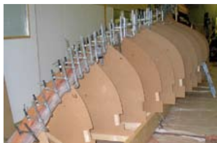
Byggigg med mallar, limning av förstäv.
